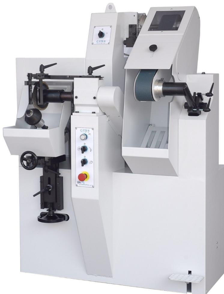
Macchina cardatrice per la scarpa montata. Modello che consente la cardatura della scarpa montata, utilizza un utensile circolare in fili di acciaio ottonato posizionato in modo che lavori tangenzialmente alla montatura. Ai lati dell'utensile si trovano due guide che, opportunamente regolate, permettono di ottenere una cardatura più o meno profonda. La sezione del filo dell'utensile varia, a secondo del pellame che si deve cardare, da un diametro minimo di mm 0,15 ad un massimo di mm 0,40.
