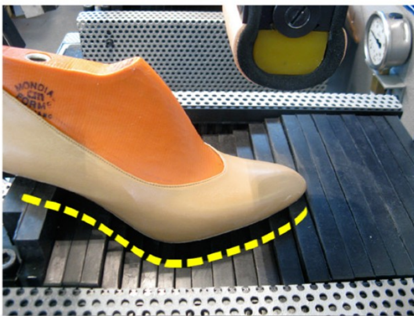
Controllo dei settori per il mantenimento della sagoma Sector pads control for shape keeping
