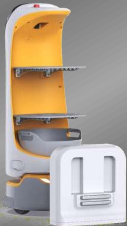
Stazione di ricarica | Charging Station
