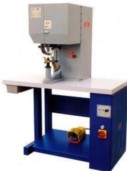
Occhiellatrice perforante insonorizzata con canale guida occhielli regolabile, completa di dispositivo salvamani, tavolo, motore e una attrezzatura di posa.
