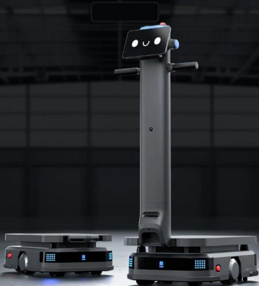
PUDU T600 è un robot industriale per il trasporto di carichi pesanti, progettato per movimentare grandi volumi. Basato su un robusto telaio mobile, è dotato di touchscreen e maniglia per un'operatività intuitiva. Caratteristiche: Schermo integrato per l'uso diretto senza sistema di controllo centrale. Include interruttore di assistenza alla spinta, pulsanti di accesso rapido e indicatori frontali per un utilizzo semplice ed efficiente.
