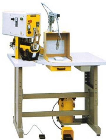
Questo centro di lavoro permette di risolvere in modo ottimale la fase di accoppiatura tra fodera, tomaia e puntale spruzzando collante a base acqua, non tossico esente da solventi, e successivamente passando la tomaia sotto pressa a caldo MOD.5000, che perfeziona il risultato dell'incollaggio sagomando inoltre la tomaia secondo una curvatura che facilita l'operazione di montaggio.
