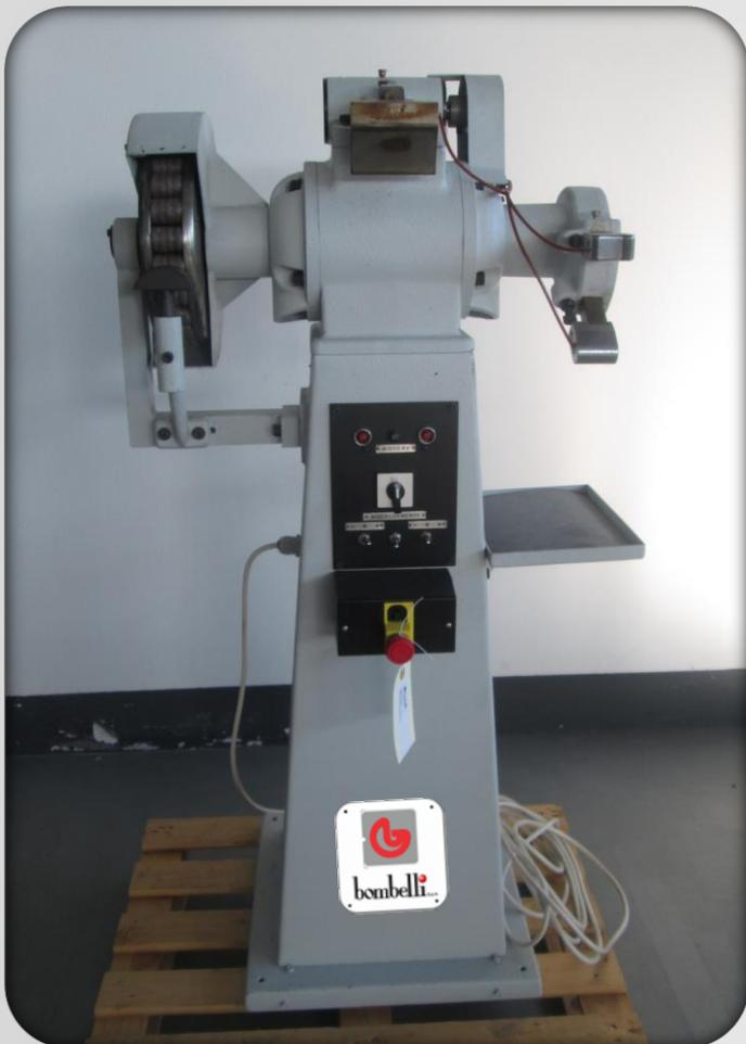
La macchina RIBATTITRICE MOD.Z-10 è una macchina progettata e costruita per eseguire la lavorazione del fondo della scarpa e la stiratura della pelle di calzature da donna. La lavorazione del fondo della scarpa è effettuata da un disco ribattitore munito di anelli che consentono di eliminare le pieghe presenti, la stiratura della pelle invece avviene tramite dei martelletti riscaldati da delle resistenze, che consentono di lisciare la pelle della scarpa.
