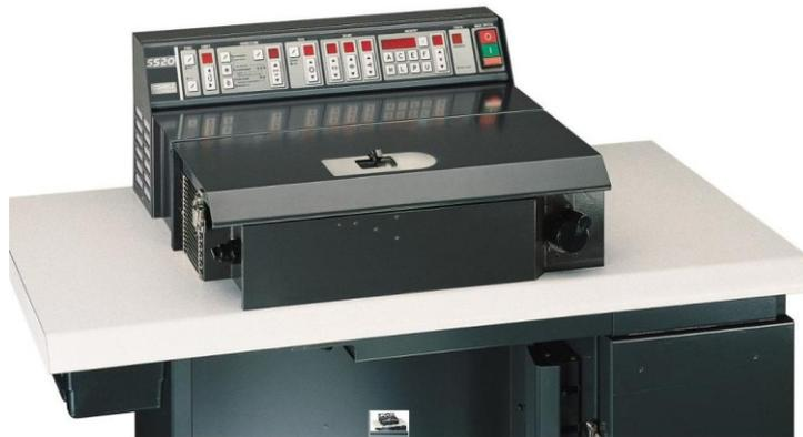
Dal corretto utilizzo delle moderne tecnologie meccaniche ed elettroniche, è scaturita la SS20 che rappresenta una profonda trasformazione della smussatrice tradizionale. Il computer installato sulla SS20 ha permesso di introdurre alcune caratteristiche assolutamente inedite. La macchina, infatti, opera sempre sotto il controllo dei sensori elettronici, per cui si auto-registra evitando all'operatore perdite di tempo e mantenendo costantemente in perfetta efficienza gli organi di lavoro.
